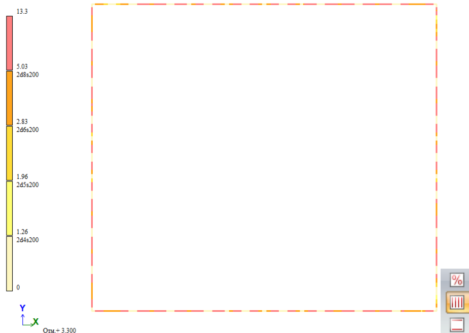
Рисунок. Требуемое поперечное армирование балок. Вертикальное направление. Вторая итерация.
